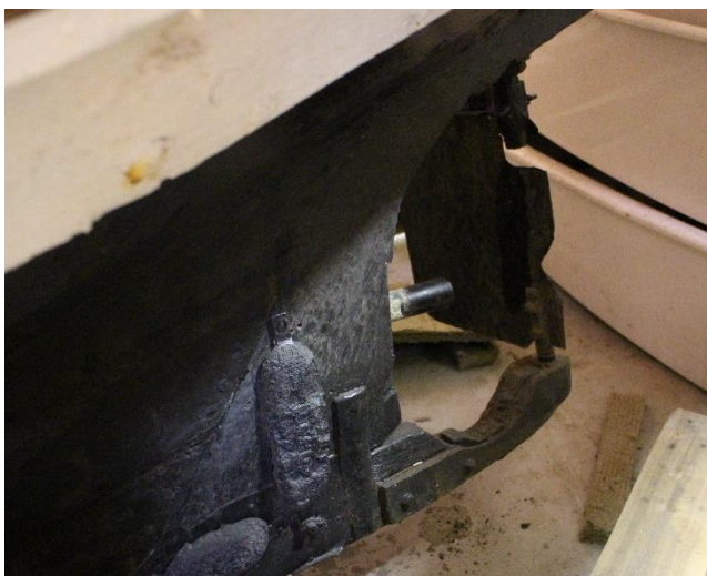
Guðmundur S GK 56, 2018. Hæll og öxull. Skrúfunar vantar. Ljósmynd. HMS
